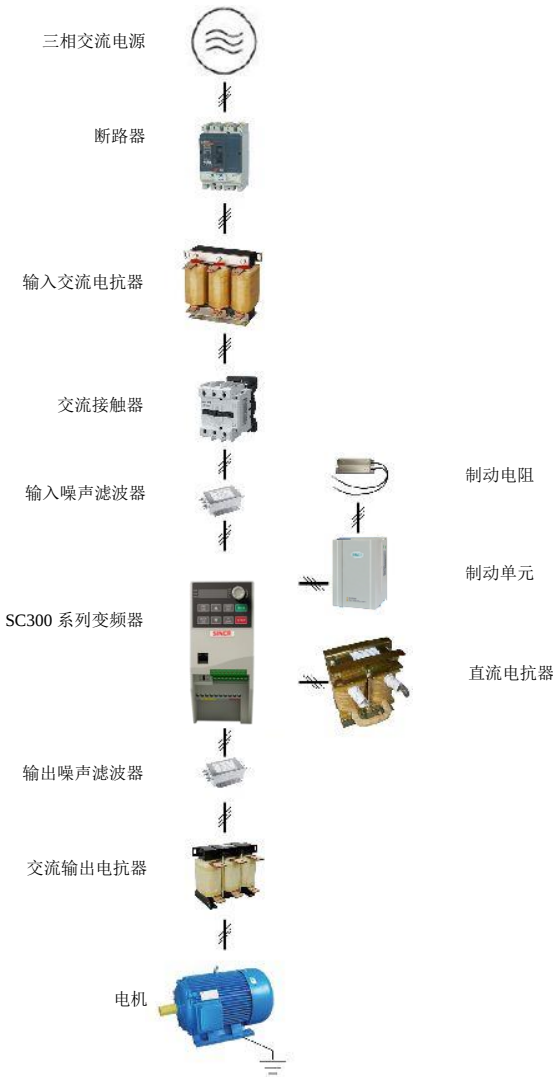
图3-3 产品与外围设备的连接
